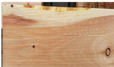
Leichte Hobelfehler an der unteren nicht sichtbaren Seite der Diele
