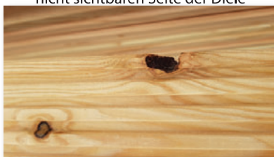
Leichte Astausbrüche an den Kanten der Diele im nicht sichtbaren Bereich
