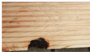
Grobe Astausbrüche an den Kanten im sichtbaren Bereich der Diele
